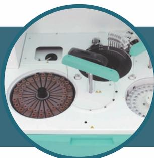
**Eficiência e produtividade.** Realiza por hora 270 testes fotométricos e a produtividade pode chegar até 450 testes associados ao módulo ISE (opcional). São 36 posições para reagentes em bandeja refrigerada, dotada de leitor de código de barras e controle do nível de líquido. A bandeja de amostras possui 30 posições para amostras e outras 15 para calibradores, controles e amostras de urgência. Acomoda tubos primários (de coleta) ou cubetas específicas.
